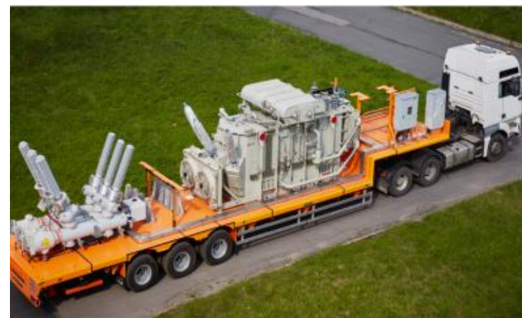
Баимский ГОК (Чукотка), ММПС 110/10(6) кВ 25 МВА, Центральный Аварийный Запас
