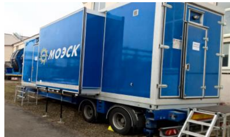
ПАО «МОЭСК», Мобильное ЗРУ 10(6) кВ, Центральный Аварийный Запас
